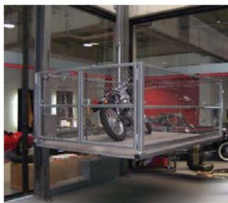
Smarte 2-Säulenhebeanlage im Meilenwerk Düsseldorf zum Transport von Motorrädern und -gespannen bis zu 600kg
